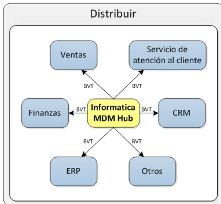
Por ejemplo, si la dirección facturación de una organización ha cambiado en Informatica MDM Hub, este puede notificar a otros sistemas de la organización (a través de mensajes JMS) acerca de la información actualizada para que los datos principales se sincronicen en toda la empresa.
